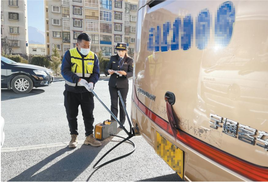
图为执法人员对车辆尾气进行检测。
