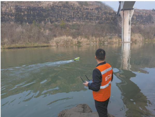
今年春运，成都高铁工务段引进了一艘无人测量船用于成渝城际高铁沿线桥梁检测。该船包含数据传输、摄像头、测深仪、推进器等配置，船长1米左右，净重6千克。“无人船”替代以前的“蛙人”下水检测，工作人员通过智能遥控，就能对铁路桥桥体下方及上下游的河床断面进行测量，生成河床断面示意图，为桥梁维护提供科学依据。这不仅提升了现场作业效率，还提高了测量的精度。
